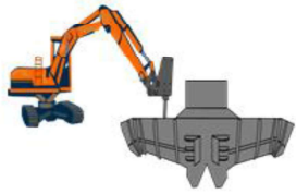
使用後の傾注樋は溶銹滓の付着がある為、重機にて大まかに取り除く
